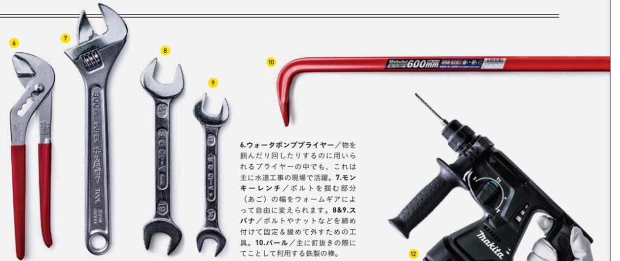
6.ウォーターポンププライヤー／物を掴んだり回したりするのに用いられるプライヤーの中でも、これは主に水道工事の現場で活躍。7.モンキーレンチ／ボルトを掴む部分(あご)の幅をウォームギアによって自由に変えられます。8&9.スパナ／ボルトやナットなどを締め付けて固定&緩めて外すための工具。10.バール／主に釘抜きの際にてことして利用する鉄製の棒。
