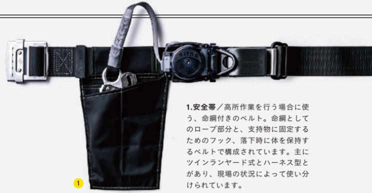
1.安全帯／高所作業を行う場合に使う、命綱付きのベルト。命綱としてのロープ部分と、支持物に固定するためのフック、落下時に体を保持するベルトで構成されています。主にツインランヤード式とハーネス型とがあり、現場の状況によって使い分けられています。
