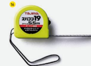
16.コンペックス／断面が湾曲したテープで長さを測定する、金属製巻尺。特定の長さで留めおけるストッパーを内蔵したのも。
