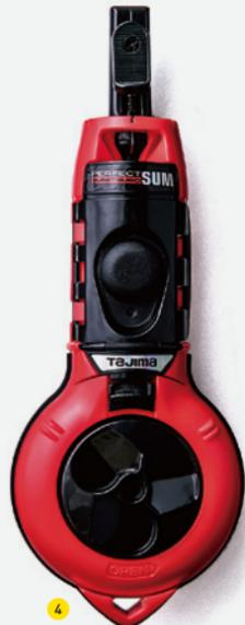
4.墨つぼ／木材などのケガキ線として直線を引く道具。木目の凹凸による線の歪みなどがなく、正しい直線を引くことができる建築現場のロングセラーです。
