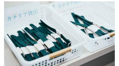
装着するだけで手軽に使える腕時計型デバイス「カナリア Plus」。熱中症リスクが高まった時にアラートが鳴り、水分補給や休憩を促します。
