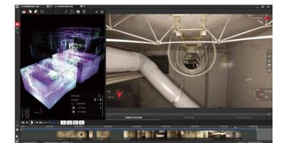
講習を受ければ初めての操縦でも簡単に狭い地下ピット内に入れることが可能。レーザー光による測距センサーで高精度3Dマップの取得も。
