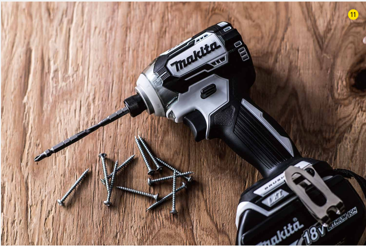
11.インパクトドライバー／回転方向に打撃を加えて大きなトルクを発生させることで、余計な力を必要とせず、かつ高速でネジやボルト、ナットの締付けなどが行えます。
