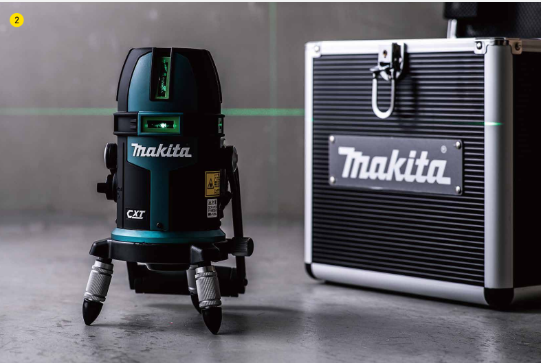
2.レーザー墨出し器／材木に直線を引いたり、基準墨となる地墨や腰墨を引くために使われる墨出し器も、今やハイテク仕様。レーザーによって水平線や垂直線を投影できます。
